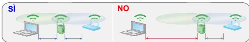
Se si utilizza in una posizione diversa, avvicinare l'Extender al dispositivo, ma sempre all'interno dell'intervallo wireless del router.
