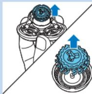
Remarque : Nettoyez uniquement une lame et une grille à la fois, car elles sont assemblées par paire. Si par erreur vous ne placez pas une lame dans la bonne grille, plusieurs semaines risquent d'être nécessaires avant que vous ne puissiez obtenir à nouveau un rasage optimal.
