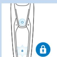
Per portare l'apparecchio in viaggio, è possibile bloccare il rasoio. Il blocco da viaggio impedisce che il rasoio venga acceso accidentalmente.
