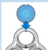
**5** Coloque novas cabeças de corte no suporte.
