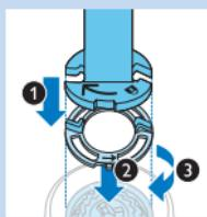
**6** Coloque o suporte do anel de retenção no anel de retenção (1), coloque-o na cabeça de corte (2) e rode-a para a direita (3) para voltar a fixar o anel de retenção.
