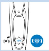
*Nota: Despues de sustituir los cabezales de afeitado, es necesario restablecer la afeitadora pulsando el botón de encendido/apagado durante 7 segundos.*
