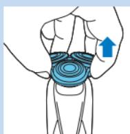
**3** Estraete il supporto della testina di rasatura dalla parte inferiore dell'unità di rasatura.
