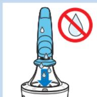
Tıraş makinesini SmartClean sistemine yerleştirmeden önce mutlaka fazla suyun temizlendiğinden emin olun.
