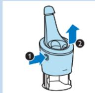
**2** Videz le liquide de nettoyage qui reste encore dans la cartouche de nettoyage avant de la jeter.
