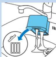
**2** Retire a recarga de limpeza vazia do sistema SmartClean e esvazie o líquido de limpeza restante da recarga de limpeza.
