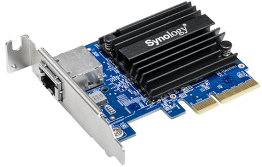
Dotato di connettore RJ-45 e in grado di supportare IEEE 802.3an/bz (10GBASE-T/NBASE-T) e 802.3x, E10G18-T1 consente di migrare facilmente a un ambiente di rete 10GbE con l'infrastruttura esistente. Supportando la compatibilità con versioni precedenti e la negoziazione automatica tra velocità dati 10Gbps, 5Gbps, 2.5Gbps, 1Gbps e 100Mbps, E10G18-T1 è una soluzione economica in grado di risolvere i problemi di trasmissione dei dati riscontrati da piccole aziende e utenti privati.
