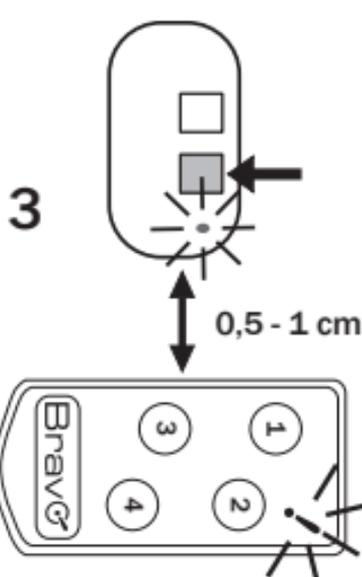
Posizionare il radiocomando originale come in figura ad una distanza di 0,5-1cm.
