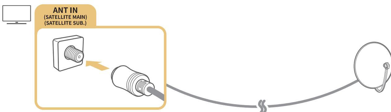
È meglio collegare entrambi i connettori usando un Multi-Switch o un DiSEqC. Switch o altro, e impostare **Tipologia connessione antenna** su **Oscillatore doppio**.
