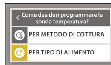
Dopo avere avviato una funzione di cottura, la rimozione della termosonda causerà l'annullamento della funzione. Ricordarsi di staccare e rimuovere la termosonda dal forno quando si estraggono le pietanze.
