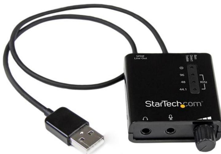
Questa scheda audio USB esterna ICUSBAUDIO2D consente di aggiungere un'uscita audio digitale S/PDIF e connessioni standard per microfono/audio analogico da 3,5 mm al sistema tramite USB: una comoda soluzione per bypassare o sostituire una scheda audio interna senza aprire il case del computer.
