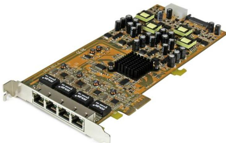
Il NIC PoE a 4 porte ST4000PEXPSE consente di aggiungere quattro porte Gigabit Power over Ethernet utilizzando un solo slot PCI Express. Ogni porta può fornire fino a 25,5 W di alimentazione combinando i dati di rete e l'alimentazione tramite un unico cavo Ethernet per un minore ingombro dei cavi e una maggiore praticità per i dispositivi PoE distanti.
