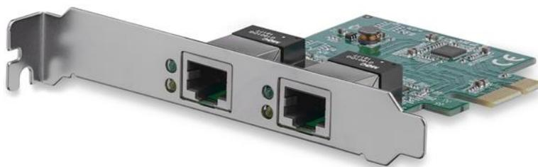
La scheda di rete PCI Express Gigabit a due porte ST1000SPEXD4 permette di aggiungere due porte Gigabit Ethernet a un client, server o workstation mediante un solo slot PCIe. Ogni porta fornisce una rete Ethernet da 10/100/1000 Mbps ed è interamente compatibile con gli standard IEEE 802.3/u/ab.
