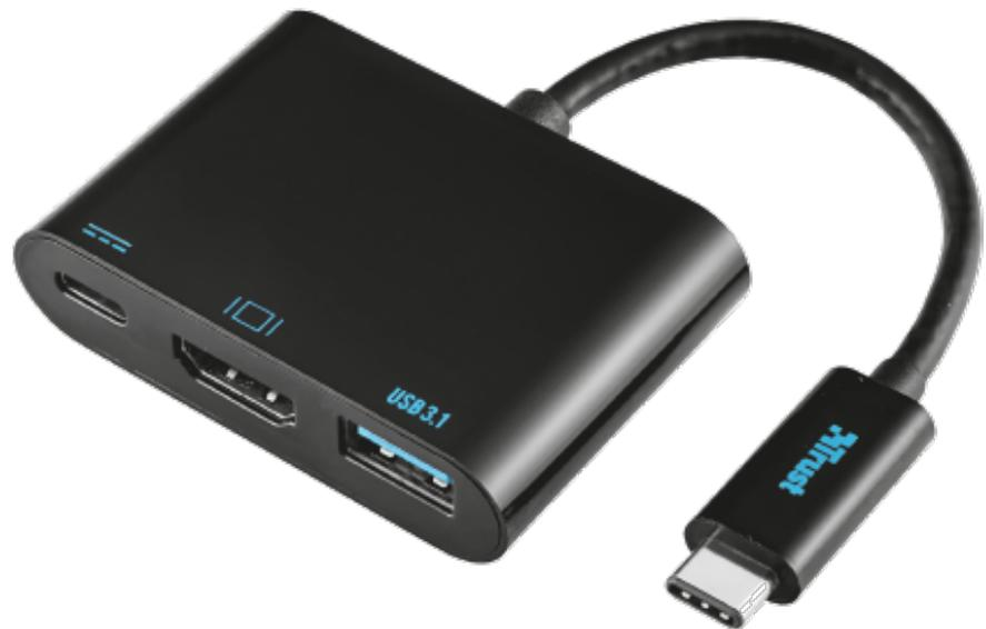
Per collegare un dispositivo USB 3.1, estendere le funzioni di monitor HDMI e alimentare un dispositivo di tipo C
