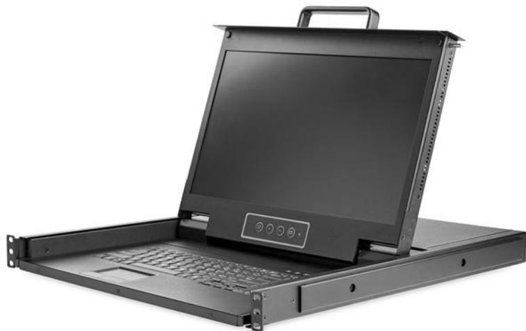
Questa console KVM con montaggio a rack offre un controllo completo su mouse, monitor e tastiera di uno o più server, collegati attraverso uno switch KVM venduto separatamente. Si tratta di una soluzione completa ed efficiente in termini di spazio, in quanto può essere installata in uno spazio rack da 1U.
