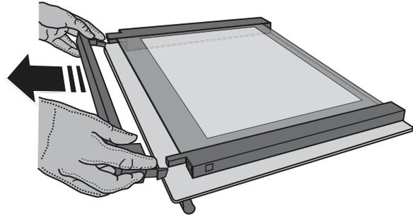
**2.** Sollevare e prendere saldamente il vetro interno con due mani, rimuoverlo e appoggiarlo su un piano morbido prima di eseguire la pulizia.
