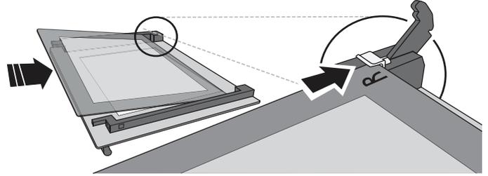
**4.** Rimontare il profilo superiore: un clic indica il corretto posizionamento. Verificare che la tenuta sia salda prima di rimontare la porta.
