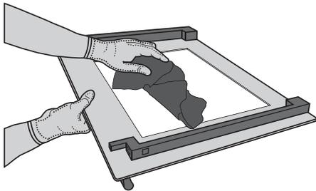
**3.** Per riposizionare correttamente il vetro interno, fare attenzione che la "R" sia leggibile nell'angolo sinistro e che la superficie lucida (non stampata) sia rivolta verso l'alto. Inserire dapprima il lato lungo del vetro indicato dalla "R" nelle sedi di sostegno, quindi abbassarlo in posizione.
