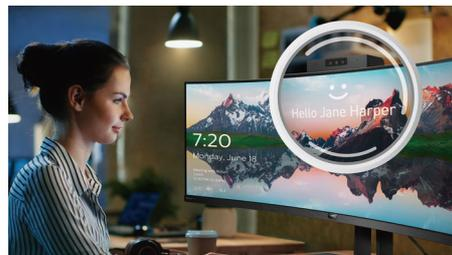
L'innovativa e sicura webcam compare quando ne hai bisogno e si ripositiona all'interno del monitor quando non è in uso. La webcam è inoltre dotata di sensori avanzati per il riconoscimento facciale tramite Windows Hello™, che consente di autenticarsi ai propri dispositivi Windows in meno di 2 secondi, 3 volte più veloce rispetto all'inserimento di una password.
