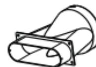
Raccordo piatto da posizionare tra la bocca di espulsione dell'aria e il tubo flessibile
