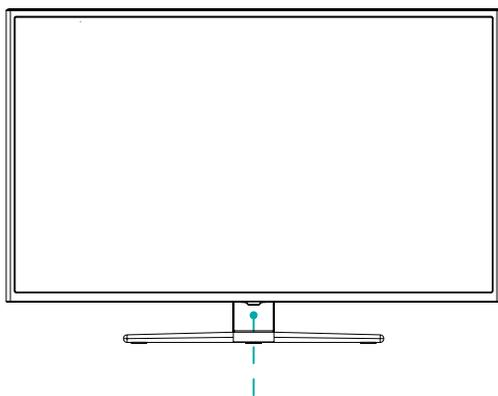
Pulsante singolo (Sensore remoto / Indicatore di alimentazione / Standby)
