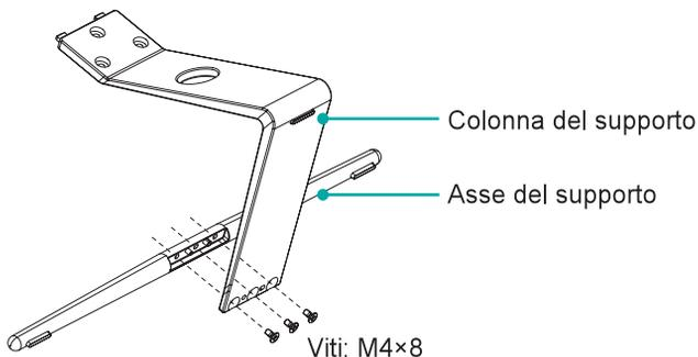
2. Fissare saldamente il Supporto di base al televisore con le 3 viti in dotazione.
