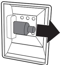
5. Sostituire la lampada con una simile (40W).
