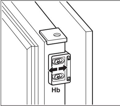
Riapplicare il quadratino sulla guida e fissarlo con le viti in dotazione. Allineare l'anta del mobile da cucina e la porta dell'apparecchiatura regolando la parte (Hb).
