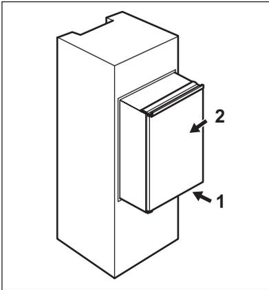
Installare l'apparecchiatura nella nicchia. Spingere l'apparecchiatura in direzione della freccia (1) finché la mascherina superiore si arresta contro il mobile. Spingere l'apparecchiatura in direzione della freccia (2) contro il mobile sul lato opposto rispetto alla cerniera.
