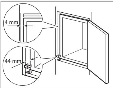
Posizionare correttamente l'apparecchiatura nella nicchia. Accertarsi che la distanza fra l'apparecchiatura e il bordo anteriore del mobile sia di 44 mm.
