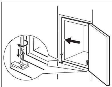
Nella parte inferiore, collegare l'apparecchiatura alla nicchia con 2 viti.
