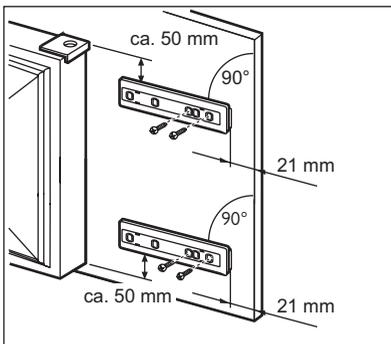
Installare la parte (Ha) sul lato interno dell'anta del mobile.
