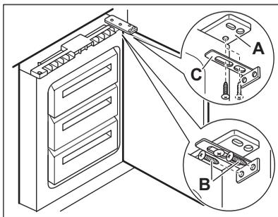
Posizionare l'apparecchiatura sul lato opposto della porta con cerniera. Se l'apparecchiatura deve essere collegata lateralmente al mobile da cucina: utilizzare la parte (C) (inclusa nel sacchetto degli accessori) come indicato in figura.
