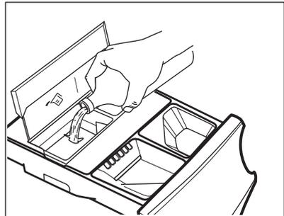
4. Versare delicatamente solo detersivo liquido nel serbatoio dell'ammorbidente AutoDose. Riempire fino al livello massimo indicato **MAX**.
