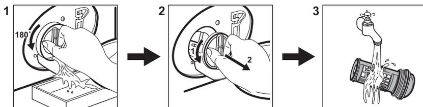
Pulire il filtro a intervalli regolati, e in particolare modo se il codice allarme **E2 1** viene visualizzato sul display.
