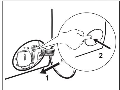
Quando si scarica l'acqua utilizzando la procedura di scarico di emergenza, è necessario attivare di nuovo il sistema di scarico:
