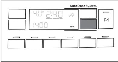
5. Per impostare il dosaggio di base sfiorare i relativi pulsanti serbatoio fino a che sul display non compaiono un dosaggio per bucato predefinito e due frecce sulla parte inferiore del display. Sfiore ripetutamente il pulsante Temperatura per regolare il dosaggio verso l'alto e i tasti Centrifuga per regolarlo verso il basso. Lo step minimo è di 1 ml.
