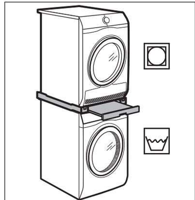
L'asciugatrice può essere installata in colonna al di sopra della lavabiancheria **soltanto utilizzando l'appropriato kit di installazione in colonna prodotto ed approvato da ELECTROLUX.**
