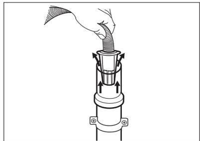
4. A un tubo verticale dotato di foro di ventilazione - Inserire il tubo di scarico direttamente in una conduttura di scarico. Fare riferimento all'immagine.
