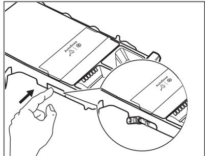
4. Premere il blocco sul retro conformemente a quanto indicato nell'immagine e sollevare il coperchio superiore per eseguire la rimozione.
