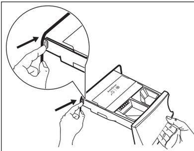
2. Rimuovere l'inserito per l'ammorbidente e, se inserito, il contenitore per il detersivo liquido.
