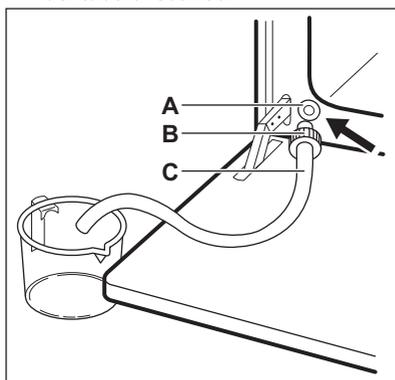
2. Sistemare l'altra estremità del tubo di scarico (C) in un recipiente. Posizionarla in modo tale che risulti più bassa della valvola di scarico (A).
