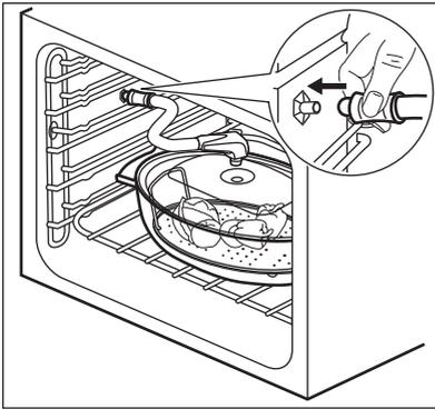
Assicurarsi di non schiacciare il tubicino dell'iniettore e che non entri in contatto con la resistenza sulla parete superiore del forno.
