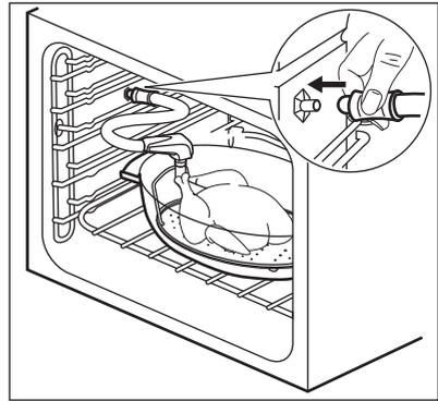
2. Sistemare la teglia sul primo o secondo livello a partire dal basso. Assicurarsi di non schiacciare il tubicino dell'iniettore e che non entri in contatto con la resistenza sulla parete superiore del forno.
