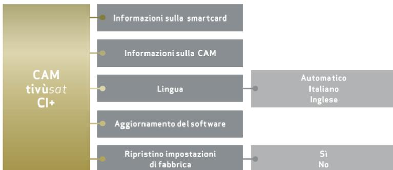
Il diagramma sopra esposto rappresenta la struttura del menu appartenente al modulo CAM **tivùsat HD**.
