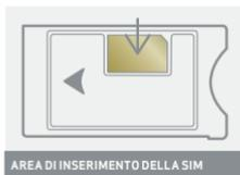
Nel caso di una smartcard formato SIM, la stessa deve essere inserita nello slot (fessura) superiore, con il chip rivolto verso il basso.
