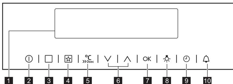
Utilizzare i tasti sensore per mettere in funzione l'apparecchiatura.
