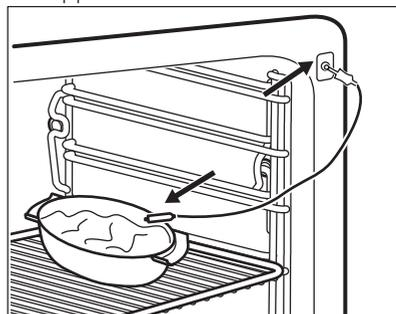
Sul display lampeggia  $\wedge$  e la temperatura interna predefinita. La temperatura è di 60 °C per il primo utilizzo e durante ogni utilizzo successivo è il valore impostato per ultimo.
