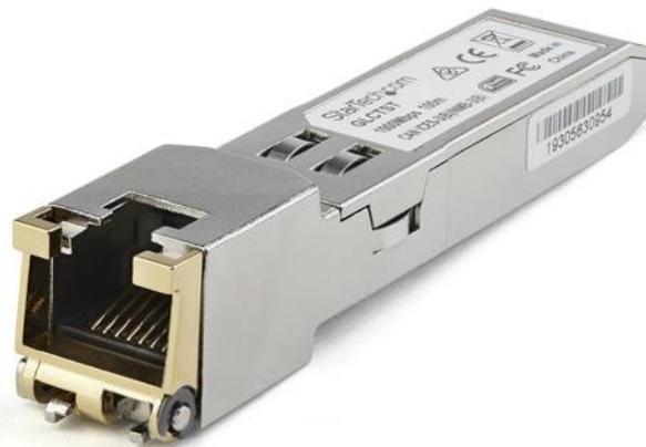
Il SFP1GETST è un modulo ricetrasmittitore SFP in rame compatibile con Juniper SFP-1GE-T progettato, programmato e testato per funzionare con switch e router prodotti da Juniper®. Offre una connettività affidabile 1 GbE su cavo in rame per le reti compatibili con 1000Base-T a una distanza massima di 100 m.
