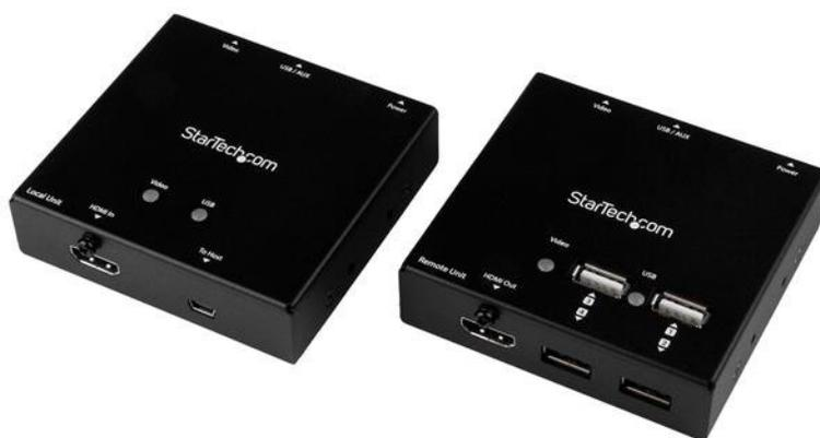
Questo kit extender HDMI® consente di trasmettere la sorgente video HD al display HDMI remoto a una distanza massima di 50,2 m. Il segnale video 1080p può essere esteso fino a 40 m utilizzando cavi schermati CAT6. L'extender è dotato di un hub USB 2.0 a 4 porte integrato che consente anche di collegare quattro periferiche USB remote in corrispondenza del display.
