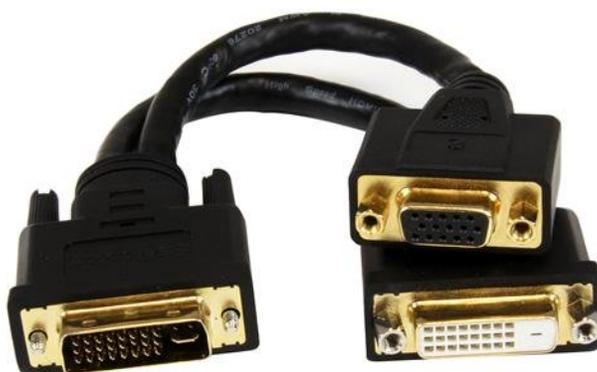
Il cavo splitter Wyse DVI DVI92030202L presenta un connettore DVI-I maschio che si divide in un cavo DVI-D femmina e in un cavo VGA HD15 femmina consentendo il collegamento contemporaneo di un display o proiettore DVI-D e VGA al terminale Wyse.
