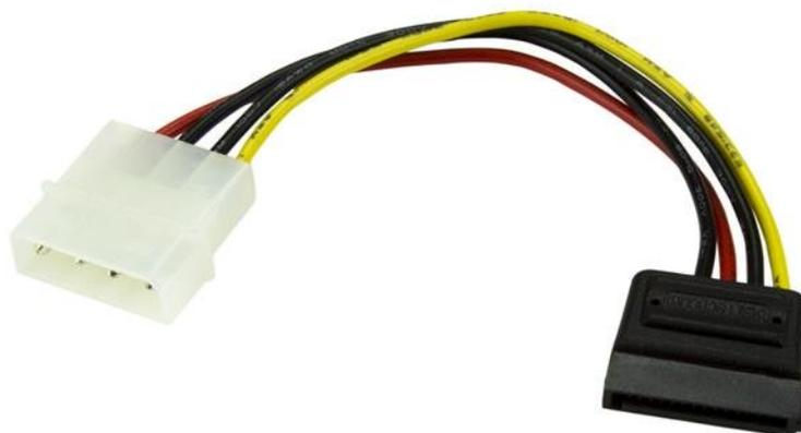
Questo adattatore per cavo di alimentazione (LP4) a SATA 4 Pin da 15 cm presenta un connettore maschio Molex (LP4) 4 Pin e un connettore di alimentazione SATA femmina che consente di alimentare un disco rigido ATA seriale tramite un collegamento LP4 tradizionale eliminando la necessità di aggiornare l'alimentazione del computer per la compatibilità con i dischi rigidi SATA. L'adattatore a SATA è dotato della garanzia a vita di StarTech.com.
