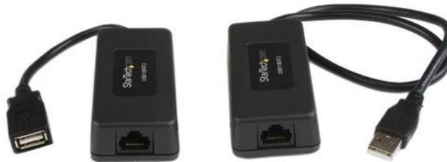
L'extender USB 1.1 USB110EXT2 permette di estendere una connessione USB 1.1 su distanze che raggiungono i 40 metri tramite cavi Cat5 o Cat6 standard, per superare il limite abituale di 5 m per dispositivi USB 1.1; inoltre consente di conservare in tutta sicurezza il computer host in una posizione remota.
