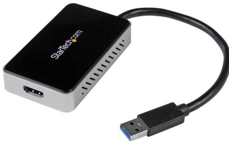
L'adattatore USB 3.0 a HDMI® USB32HDEH trasforma una porta USB 3.0 in una porta di uscita HDMI con supporto video 1920x1200/1080p. L'adattatore presenta un USB pass-through 3.0 integrato che offre una porta di collegamento invece di una porta USB utilizzata per il collegamento dell'adattatore HDMI: una soluzione ideale per gli utenti di Ultrabook™ o laptop in cui è disponibile un numero limitato di porte USB.
