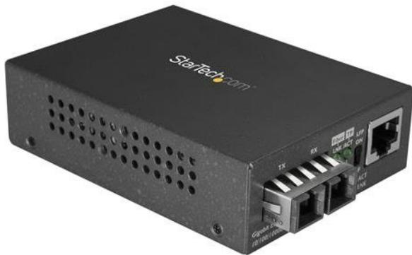
Questo convertitore multimediale a fibra consente di estendere una rete Gigabit Ethernet (1000 Mbps) fino a 550 m tramite una connessione in fibra multimodale sulle reti 1000BASE-SX.
