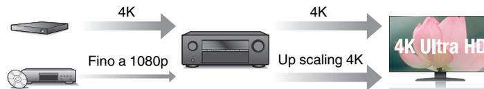
Questa unità è dotata di una funzione di upscaling del video 4K che consente l'invio in uscita di un segnale video SD (Standard Definition) su collegamento HDMI alla risoluzione 4K (3840 × 2160 pixel). Questa funzione consente al dispositivo di essere collegato a un televisore usando un unico cavo HDMI e produce immagini ad alta definizione per qualsiasi sorgente video.
