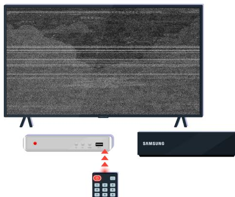
Utilizzando un telecomando Multi-Brand Remote (MBR) o un telecomando universale ed il proprio telecomando non sia in grado di controllare un dispositivo esterno, avvicinare il dispositivo esterno alla One Connect Box.
