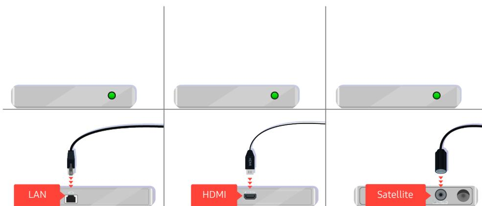
In caso di uso di un set-top box, verificare la connessione del cavo. Il cavo da controllare dipende dal tipo di set-top box utilizzato.
