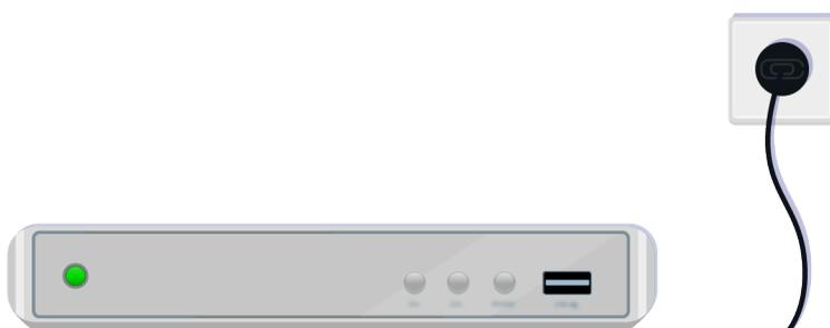
Qualora non si accenda, accertarsi che il cavo di alimentazione sia correttamente collegato al dispositivo ed alla presa di corrente
