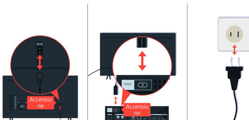
Scollegare e ricollegare i cavi di alimentazione ed i cavi HDMI sul retro del TV ed il One Connect (OC) Box, quindi scollegare il cavo di alimentazione e ricollegarlo ad una presa elettrica a parete.
