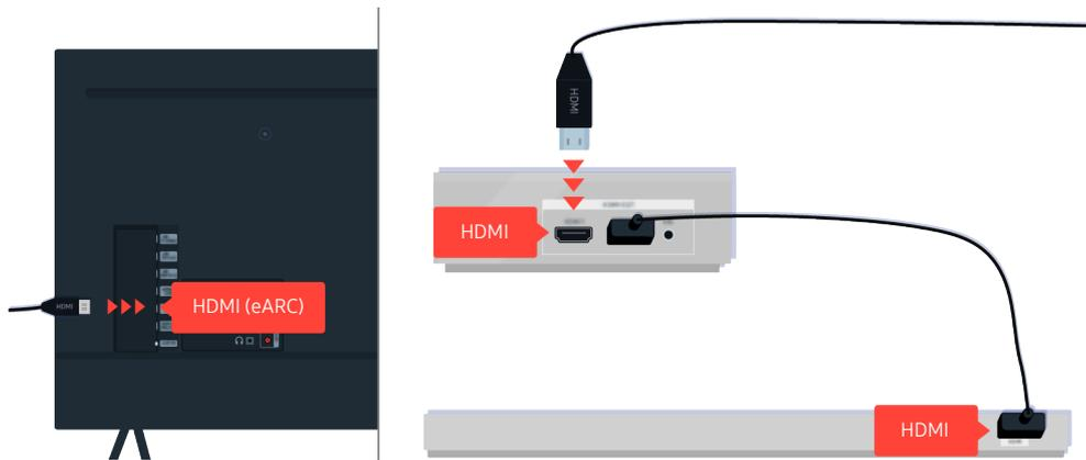
Se la Sound Bar è collegata ad un ricevitore che a sua volta è collegato al TV mediante un cavo HDMI, verificare il connettore HDMI sul retro del TV. Il cavo deve essere collegato alla porta HDMI (eARC) del TV.
