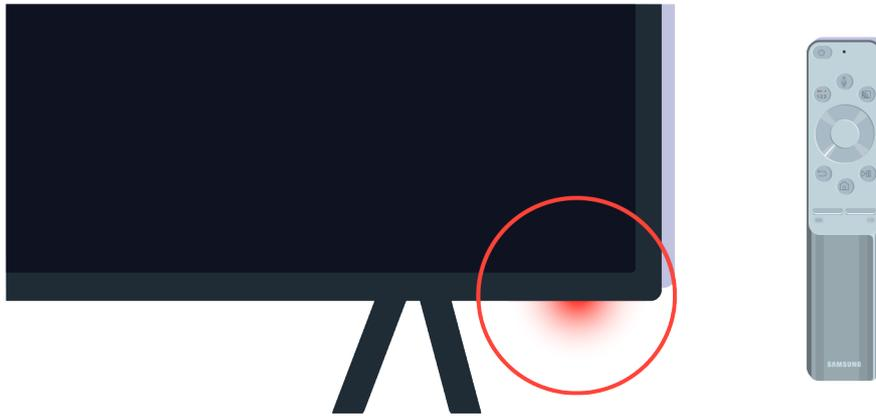
Controllare nuovamente il sensore del telecomando. Se il LED è acceso, premere il tasto di accensione del telecomando per accendere il TV.
