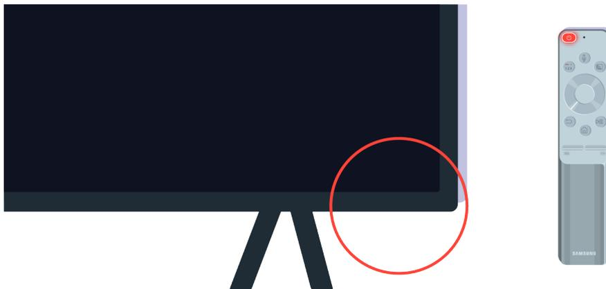
Se il sensore del telecomando si spegne premendo il tasto di accensione, il TV è correttamente collegato all'alimentazione.
