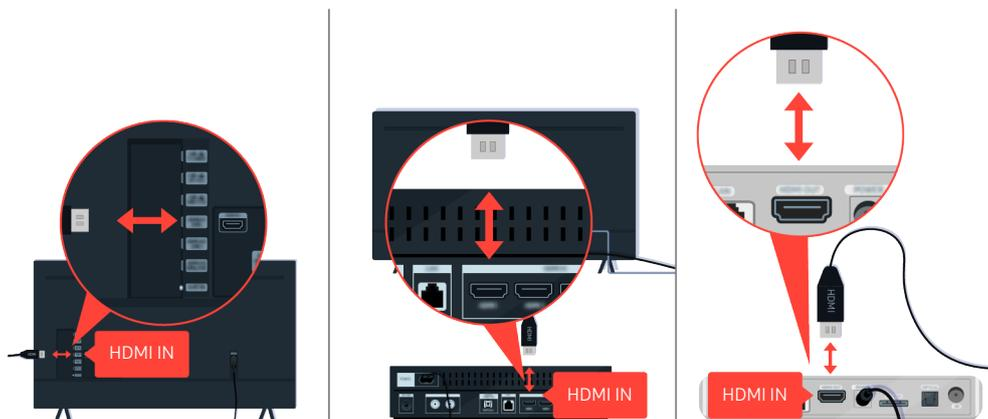
Scollegare e ricollegare i cavi di alimentazione ed i cavi HDMI sul retro del TV ed il One Connect (OC) Box, quindi scollegare il cavo di alimentazione e ricollegarlo ad una presa elettrica a parete.
