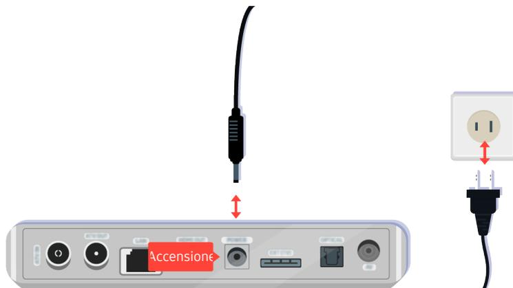
Qualora non si accenda, accertarsi che il cavo di alimentazione sia correttamente collegato al dispositivo ed alla presa di corrente
