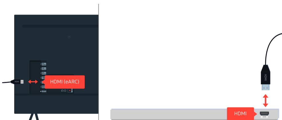
Se dalla barra audio non proviene alcun audio ed è collegata al TV mediante un cavo HDMI, verificare il connettore HDMI (eARC) sul retro del TV.
