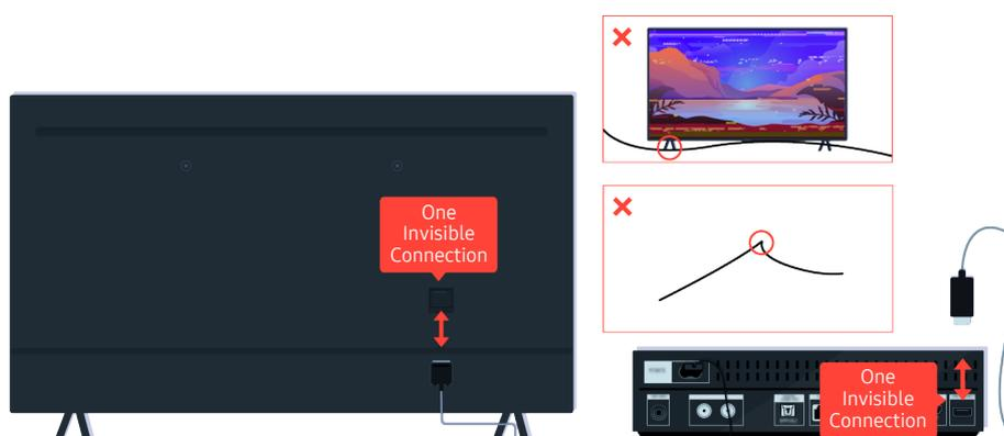
Se il problema persiste ed il proprio TV usa la One Invisible Connection, scollegare e ricollegare la One Invisible Connection alla TV ed al One Connect (OC) Box. Accertarsi che la One Invisible Connection non sia schiacciata o piegata eccessivamente.
