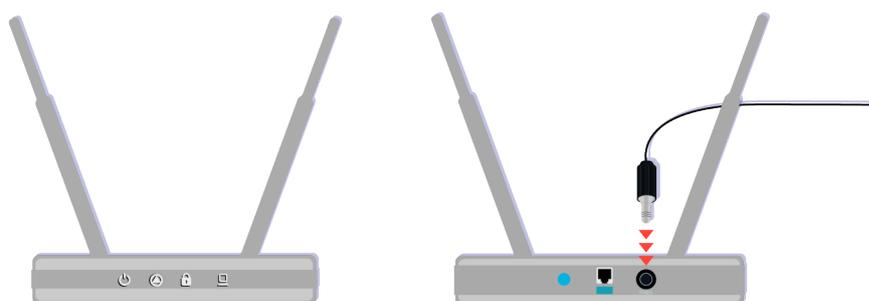
Verificare che l'access point sia collegato a Internet. In caso contrario, potrebbe essere necessario scollegare e ricollegare il cavo di alimentazione dell'access point.
