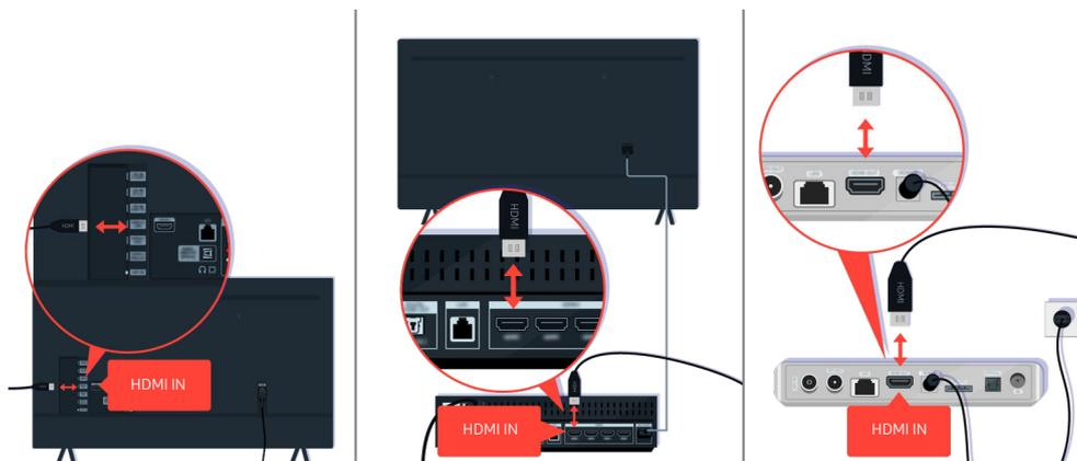
Controllare la connessione dei cavi dell'antenna e delle porte HDMI.
