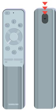
Se non si notano segnali infrarossi, sostituire le batterie del telecomando.
