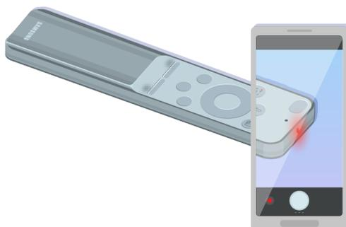
È possibile verificare se il segnale viene trasmesso premendo il tasto di accensione ed osservando il frontalino del telecomando attraverso la telecamera del proprio smartphone.
