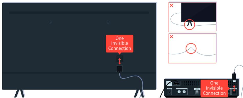
Scollegare e ricollegare il cavo One Invisible Connection tra il TV ed il Box One Connect (OC). Accertarsi che il cavo One Invisible Connection non sia schiacciato o piegato eccessivamente.
