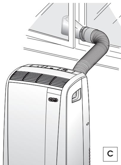
Limitare al minimo possibile la lunghezza e le curve dei tubi aria evitando qualunque strozzatura.
