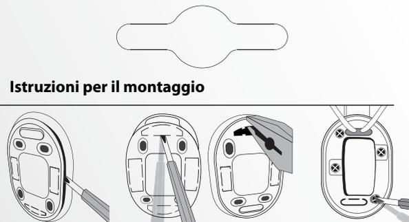
❶ Separare la calottina dalla base con un cacciavite: fare pressione e ruotare la punta di 45° nel punto indicato.
