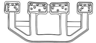
nella parte posteriore del cestello e utilizzabile per sostenere in posizione verticale pentole e casseruole e ottimizzare in tal modo lo spazio.
