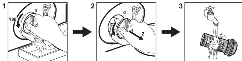
Pulire il filtro a intervalli regolati, e in particolare se il codice allarme **E20** viene visualizzato sul display.
