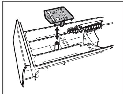
3. Verificare che tutti i residui di detersivo vengano rimossi dalla parte superiore e inferiore dell'incasso.
