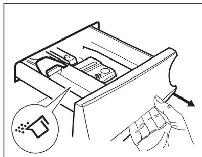
4. Per utilizzare il detersivo liquido, ruotare l'insetto verso il basso.
