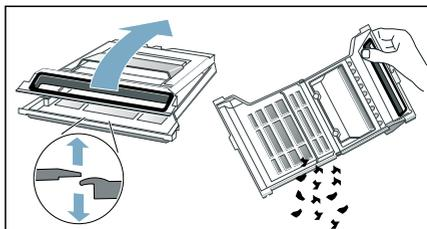
8. Sciacquare abbondantemente sotto acqua corrente il filtro del vano di deposito della lanugine e asciugarlo.
