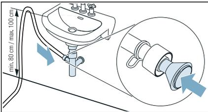
Assicurare il punto di raccordo con una fascetta stringitubo (area di serraggio 12-22 mm, reperibile nei negozi specializzati). Per il collegamento a un sifone bisogna accertarsi che il tubo di scarico venga convogliato a un'altezza minima di 80 cm e massima di 100 cm.
