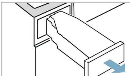
11. Versare circa 1 ½ un litro di acqua calda del rubinetto nel contenitore della condensa.
