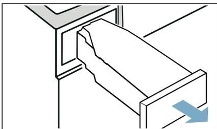
9. Inserire il contenitore dell'acqua di condensa fino all'arresto.
