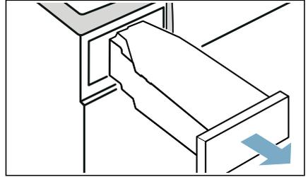
7. Versare nel contenitore della condensa un flacone del prodotto originale per la cura dell'apparecchio insieme a 1 ½ litro circa di acqua calda del rubinetto.
