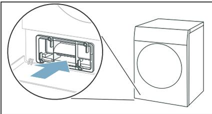
**Avvertenza:** È possibile inserire il coperchio dello scambiatore di calore soltanto il vano di deposito della lanugine si trova nell'apparecchio.
