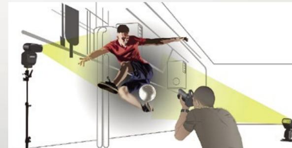
Il flash incorporato è stato usato come commander per attivare i due lampeggiatori SB-500 a distanza tramite connessione wireless e creare un effetto tridimensionale dinamico. L'emissione flash di ciascuna unità lampeggiatore può essere controllata manualmente per ottenere il risultato desiderato.
