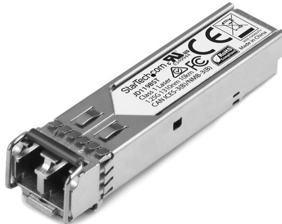
Il prodotto JD119BST è un modulo ricetrasmittitore per fibra compatibile con HP JD119B, progettato, programmato e testato per operare con switch e router a marchio HP®. Offre un'affidabile connettività da 10 GbE tramite cavo in fibra per le reti compatibili con 1000BASE-LX, a una distanza massima di 10 km.
