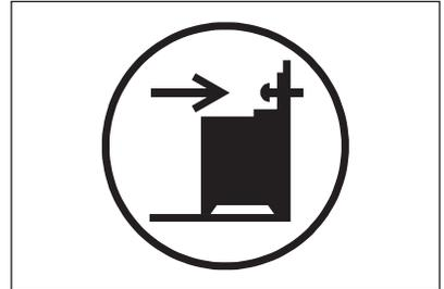
1. Installare la protezione antiribaltamento 317 - 322 mm in basso rispetto alla superficie superiore dell'apparecchiatura e 80 - 85 mm dal lato della stessa nel foro rotondo su una staffa. Avvitarla al materiale solido o usare un apposito rinforzo (parete).
