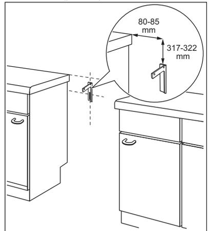
2. Il foro si trova sul lato sinistro del retro dell'apparecchiatura. Sollevare il lato anteriore dell'apparecchiatura e posizionarlo nel centro dello spazio tra i ripiani. Nel caso in cui lo spazio fra i ripiani sia superiore rispetto alla
