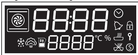
Il display mostra i parametri e i valori relativi all'operazione attualmente selezionata. Per utilizzarlo è sufficiente ruotare la manopola funzioni e la manopola temperatura per selezionare i valori indicati.
