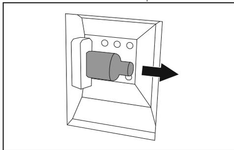
5. Sostituire la lampada con una simile (40W).
