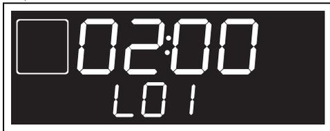
3. Ruotare la manopola temperatura per impostare la durata della Pirolisi da un minimo di 2 ore fino ad un massimo di 3 ore.
