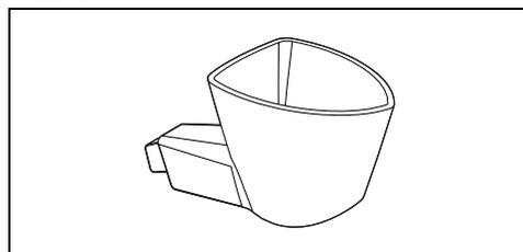
Utile per caricare l'acqua all'interno del serbatoio.
