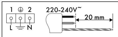
Cavo tripolare 3 x 1,5 mm<sup>2</sup>.
