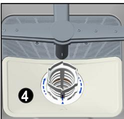
Tirare e rimuovere il filtro metallo/plastica. 3 Poi estrarre il filtro residui grossi del micro filtro.2 Sciacquare con abbondante acqua corrente. Rimontare il filtro metallo/plastica. Inserire il filtro residui grossi nel micro filtro in modo che i marchi corrispondano l'uno all'altro. Collegare il micro filtro nel filtro metallo/plastica e ruotarlo in direzione della freccia; esso è bloccato quando la freccia sul micro filtro può essere vista attraverso. 4
