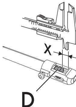
4. Regolare l'afflusso d'aria spostando il tubo Venturi "D", fino ad ottenere la distanza "X" riportata nelle tabelle relative (vedi "Tabella caratteristiche bruciatori e ugelli", alla voce "Aria primaria (mm)"); successivamente, stringere la vite "A".
