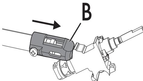
3. Riportare il supporto "B" nella posizione iniziale, in modo da coprire completamente l'ugello "C".
