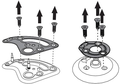
5. Rimuovere la guarnizione presente sulle termocoppie e candele da ogni bruciatore.
