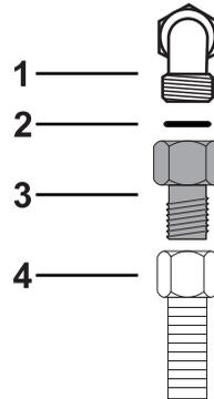
Per alcuni modelli, invece, è sufficiente collegare il raccordo **3** al raccordo gas **1** (filetto  $\frac{1}{2}$ " ISO 7-1).
