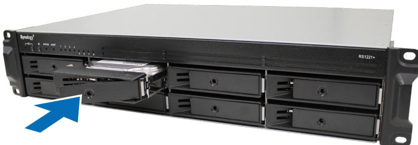
**Nota:** verificare che il vano unità sia completamente inserito. In caso contrario, l'unità potrebbe non funzionare correttamente.
