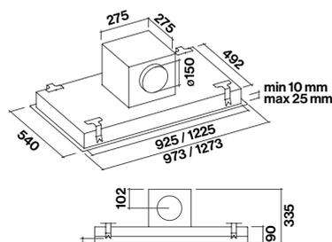
Motore sottotetto installato sulla cappa
