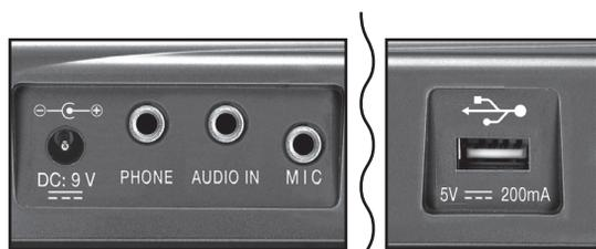
**DC 9 V** -Prise pour adaptateur de réseau (fourni).
