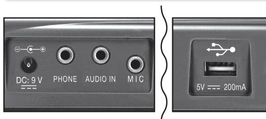
**DC 9 V** -Gniazdo zasilacza (dołączony).
