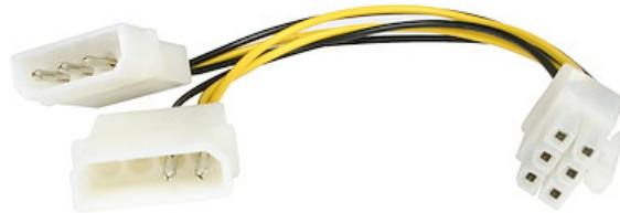
L'adattatore di alimentazione per schede video LP4 a PCI Express 6 pin da 15 cm converte un connettore di alimentazione LP4 standard dell'alimentazione di corrente esistente in un connettore di alimentazione scheda video PCI Express 6 pin, permettendo l'installazione di una scheda grafica PCIe senza dover aggiornare l'alimentazione di corrente del computer.
