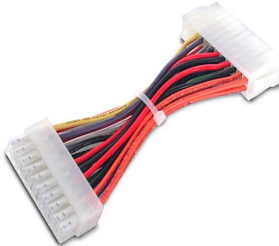
L'adattatore di alimentazione ATX2024FM 20 a 24 pin offre un modo conveniente per collegare una scheda madre compatibile con 20 pin a un alimentatore con connettore a 24 pin. In questo modo i modelli più recenti a 24 pin possono essere utilizzati con una scheda madre a 20 pin di precedente generazione.
