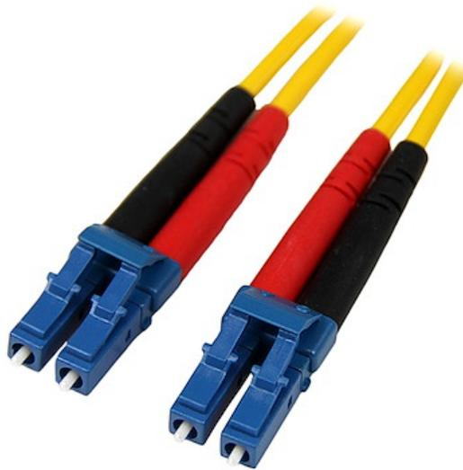
Il cavo in fibra duplex a modalità singola LC a LC 10 m SMFIBLCLC10 presenta una fibra da 9/125 micron per trasmissioni dati ad alta velocità ed elevata larghezza di banda tramite reti Gigabit Ethernet e Fiber Channel con il supporto di applicazioni in modalità singola.
