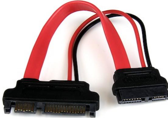
L'adattatore slimline SATA a SATA SLSATAADAP6 presenta un connettore slimline Serial ATA a un'estremità e un connettore dati SATA standard (con connettore di alimentazione SATA) all'altra consentendo il collegamento di un lettore ottico slimline SATA a una scheda madre standard e alle connessioni di alimentazione.
