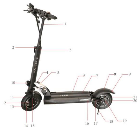
1. Tubo anteriore 2. Leva blocco manubrio 3. Piantone sterzo 4. Fermo di sicurezza 5. Leva blocco telaio 6. Porta di
