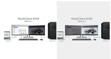
Con lo switch integrato KVM MultiClient, è possibile controllare due diversi PC con un'unica impostazione monitor-tastiera-mouse. Un comodo pulsante consente di cambiare rapidamente sorgente. Comodo per i dispositivi che richiedono la potenza di calcolo di due PC o la condivisione di un unico grande schermo per visualizzare le schermate di due PC.
